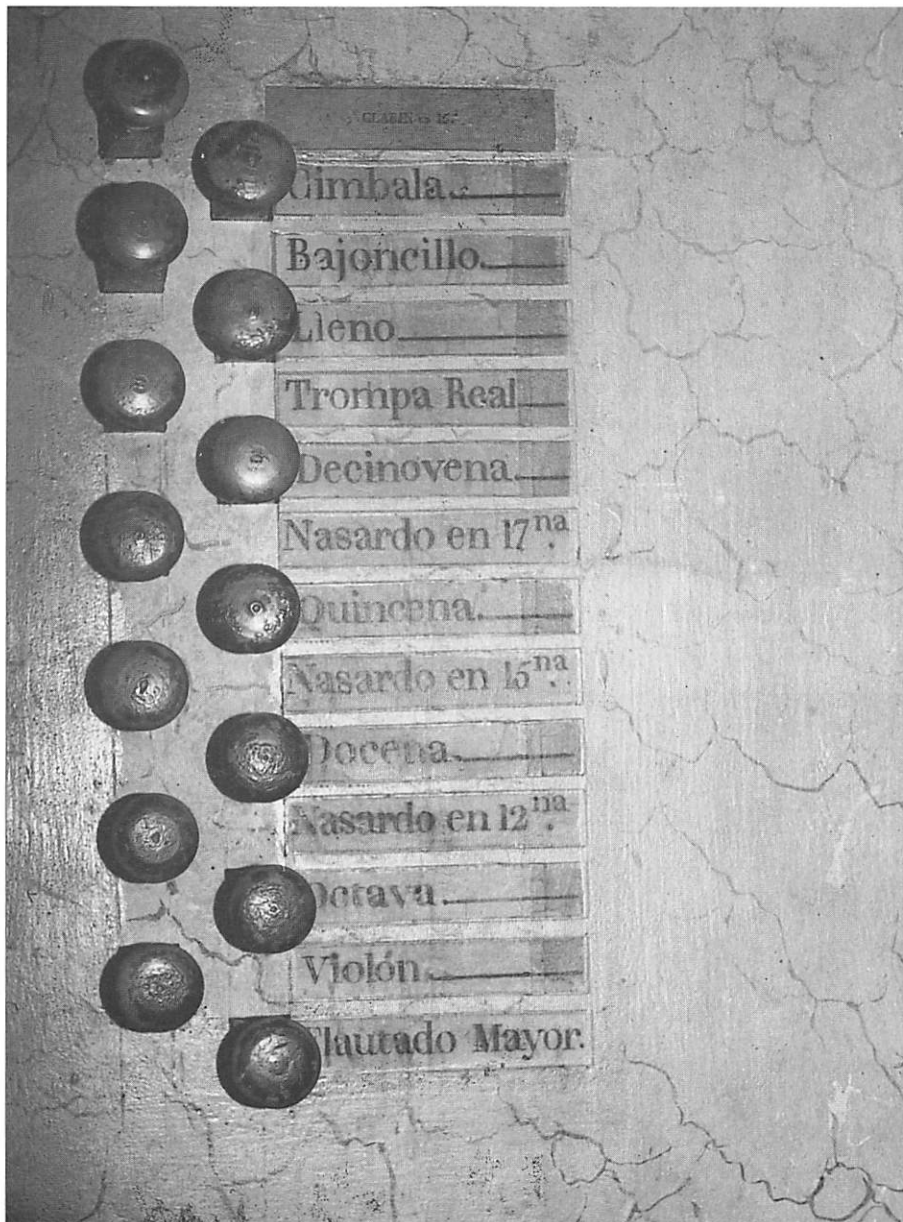
Foto 4. Órgano de Mirambel. Tiradores de registro y cartelera de Mano Izquierda. (Foto R. Miravet 1996).
